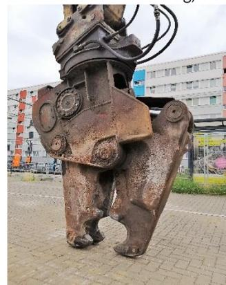
**Wie das Maul eines Knochens zermalmenden Tyrannosaurus rex ragt die Abbruchscheere am Caterpillar empor.** 2,6 Tonnen wiegt allein diese Kombischere VT40, die mit ihren drei Scherenscheiteln mühelos Metallpfeiler und Betonpfosten durchschneidet. Baggerfahrer Andreas (49), genannt „Assi“, verkörpert den Traum vieler Kinder. An den Schalthebeln der Zerstörung bewegt er die Höllmaschine sicher an den Grundfesten des Kaufhallenvordachs entlang. Souverän
